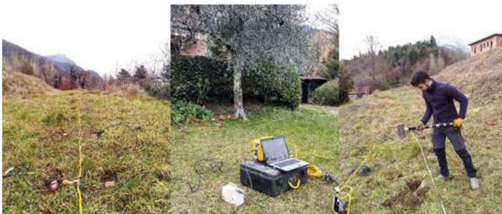
Stendimento sismico M.A.S.W.
