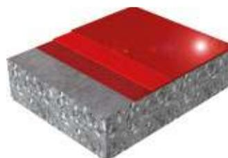
da **Sikafloor-156** caricato con il 50% in peso di sabbia di quarzo di granulometria 0,1/0,3 mm. Sulla superficie fresca è stato successivamente eseguito uno spolvero di sabbia di quarzo 0,3-0,9 mm.
