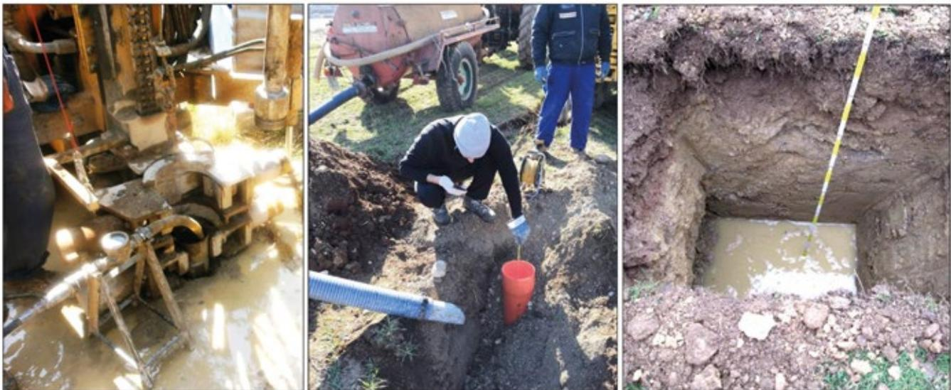
base alle disponibilità di cantiere e alle profondità preventivate del sistema di infiltrazione, solitamente la prova di permeabilità in sito viene eseguita, in foro di sondaggio, in pozzetto superficiale aperto, o ancora in pozzetto superficiale con inserimento di un tubo cieco e richiuso per simulare una prova in foro di sondaggio.
